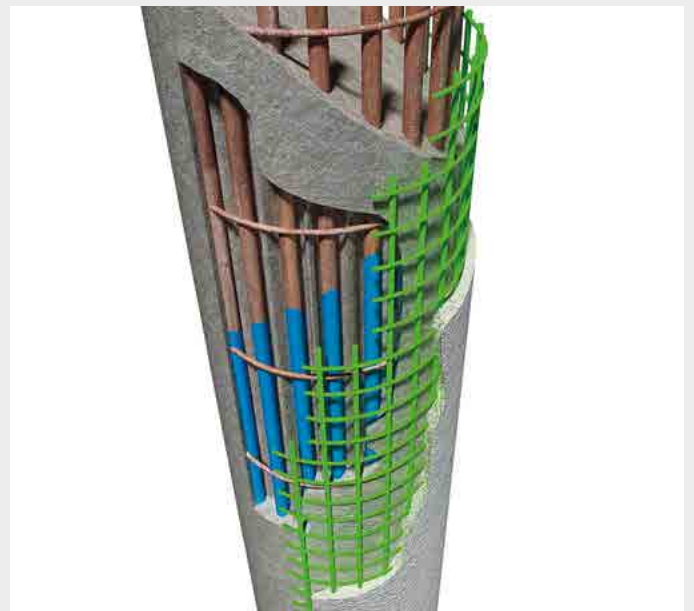
CONSOLIDAMENTO DI COLONNE E PILASTRI
